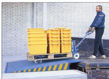
Перегрузочный мост в рабочем положении.
