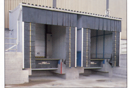
Решение с комбинацией перегрузочного моста и герметичного тамбура.
